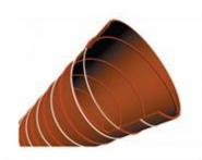
Tubo com uma parede de tecido de fibra de vidro recoberto com silicone, com uma espiral de aço. **Aplicação:** Sucção de ar e gases, adequado para o processo de produção de papel, plásticos e automóvel.
