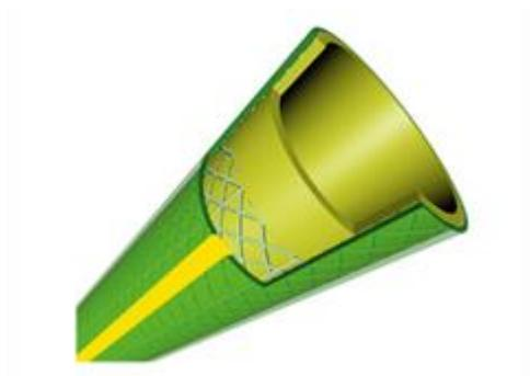
Tubo fabricado com duas camadas de PVC flexível com reforço de fio de poliéster.
