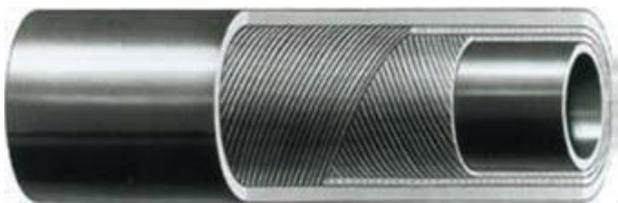
Tubo fabricado em borracha NBR com reforço de fio de poliéster e cobertura em NBR/EPDM.
