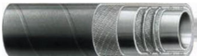
Tubo fabricado em borracha SBR, com reforço de fio de poliéster e com uma espiral em aço embutida numa cobertura em borracha SBR.
